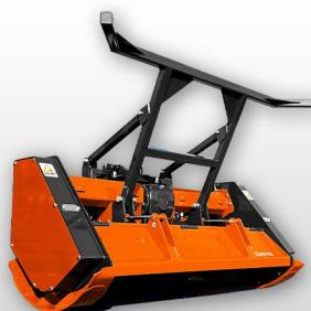
**Толкающая рама** отталкивает предметы от трактора. Она может быть оснащена гидравлическими цилиндрами регулировки наклона (тогда трактор должен иметь еще одну двухпоточную гидравлическую линию).
