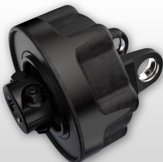
**Гидродинамические муфты (опция).** Автоматическая защитная муфта. Срабатывает в момент перегрузок, ограничивая передаваемый на мульчер крутящий момент. После прекращения забивания - самостоятельно переходит в рабочий режим. Не требует обслуживания на протяжении всего срока жизни.
